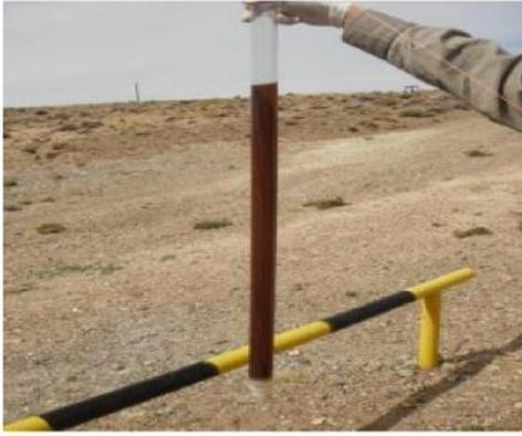
*Espesor aparente de FLNA registrado en el pozo FG28-H, ubicado a menos de un metro del sistema de purga instalado (espesor total registrado: 0,94 m)*
